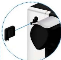
2 Inserte la boquilla de agua caliente. Los botones de Espresso, Lungo y agua caliente se encenderán.
