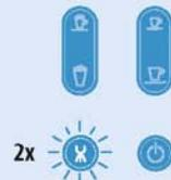
Al encender la máquina, 2 parpadeos del botón de agua caliente confirman el ajuste de 2 horas.
