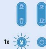
Al encender la máquina, 1 parpadeo del botón de agua caliente confirma el ajuste de 30 minutos.
