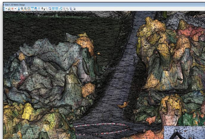
*OpenRoads Designer incluye herramientas de modelado 3D para incorporar y modificar todos los tipos de datos, incluyendo la capacidad de extraer características a nivel de suelo de mallas 3D y LiDar, así como nubes de puntos e imágenes.*
