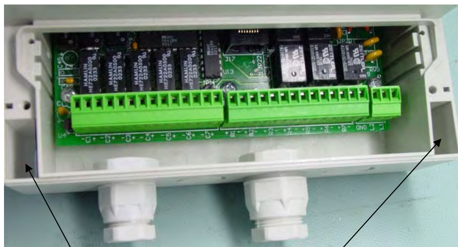
ENCAIXES NO COMPARTIMENTO DO TERMINAL P/ PARAFUSOS DE MONTAGEM
