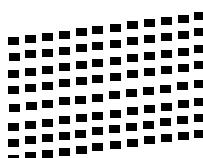
Si observa que faltan líneas, pulse **2 (No)** en el teclado de marcación y siga los pasos en la pantalla LCD.
