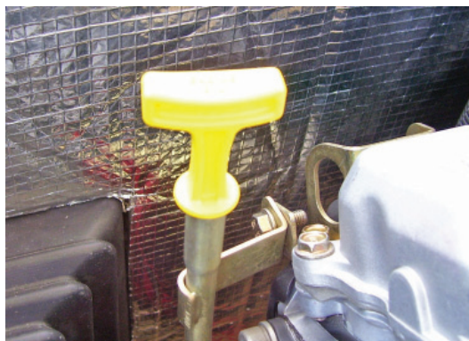
Figura 4.3 — Varilla de aceite y llenado, 12, 14, 16, 17 & 20kW
