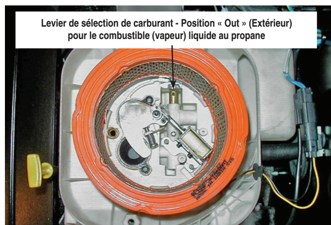
Schéma 1.8 - GT-990/ GT-999, 13, 14, 16, 17 et 20 kW (couvercle de boîte à vent retiré)
