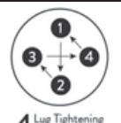
4 Lug Tightening Pattern
