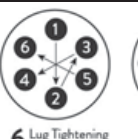
6 Lug Tightening Pattern
