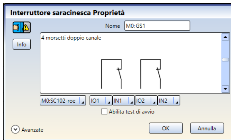
Figura 251. Proprietà dell'ingresso interruttore
