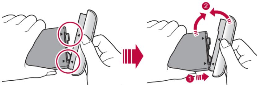
2 Coloque con cuidado la batería y la unidad del módulo en el dispositivo. Puede escuchar un clic para asegurarse de que el dispositivo está bien colocado.
