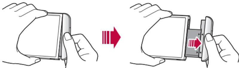
3 Sostenga la batería y el módulo con ambas manos y sepárelos, como se muestra en la figura.
